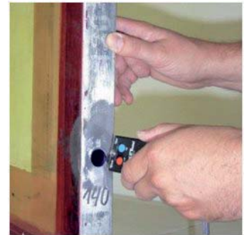
Der RFID-Transponder ist sicher und lösemittelfest befestigt.
